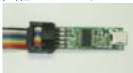
図4. オスピンに変更し、ケーブル引出し
