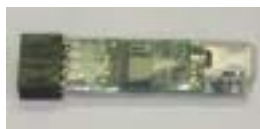
図5. 熱収縮チューブでカバー
